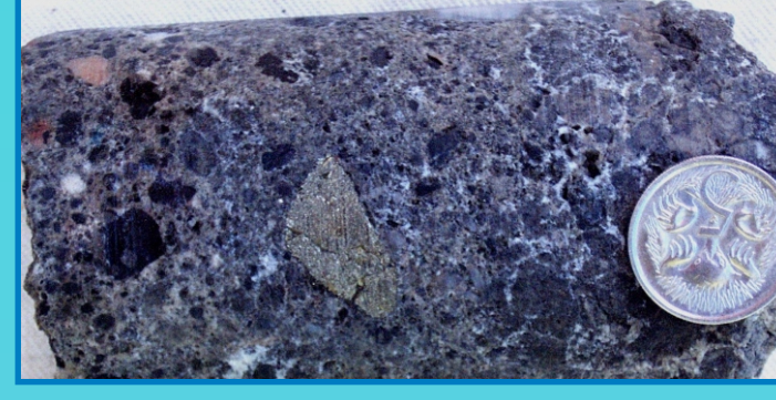
Sulphide clast in Wernecke Breccia.
